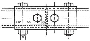
Ø = 14mm (tube≥40mm<50mm diam. ext.) 16mm (tube≥50mm diam. ext.)
